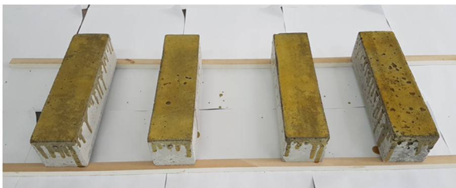
Figura 33 – Aplicação do Primer
