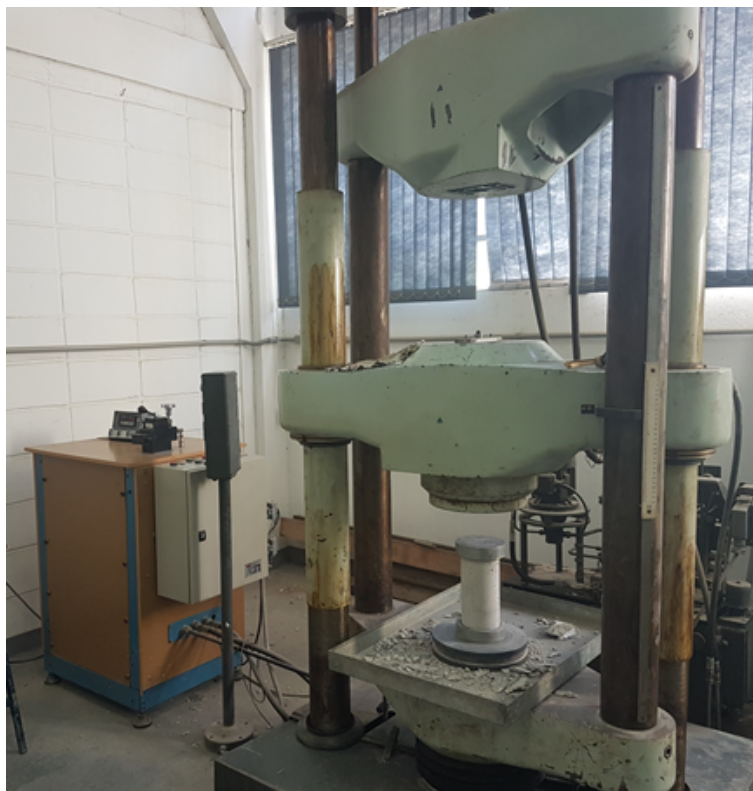
Figura 37 – Máquina de Ensaio de Compressão
