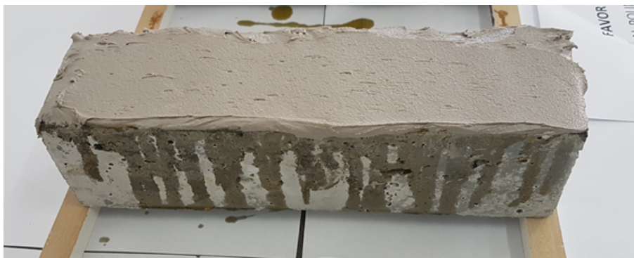
Figura 35 – Aplicação do Adesivo
