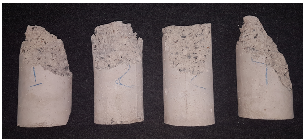
Figura 48 – Corpos de Prova Cilíndricos Rompidos
