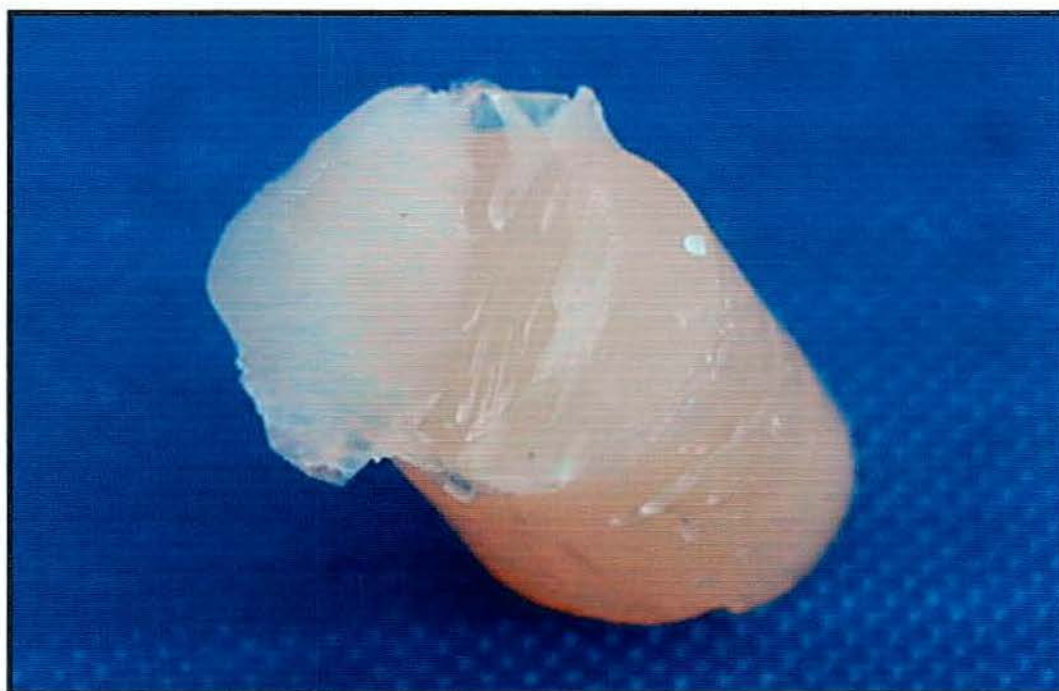
FIGURA 19 - Fratura mista - superfície do cilindro de resina composta.
