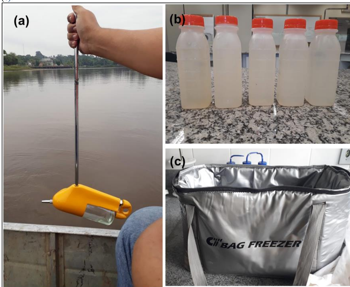
Figura 8. Coleta de água com DH-48 Hidromec (a), armazenamento das amostras (b) e transporte (c).
