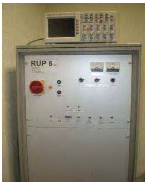
Figura 10 – Fonte de alta tensão, fabricante GBS Elektronik, modelo RUP6-20, e osciloscópio, fabricante Tektronics, modelo 2014.
