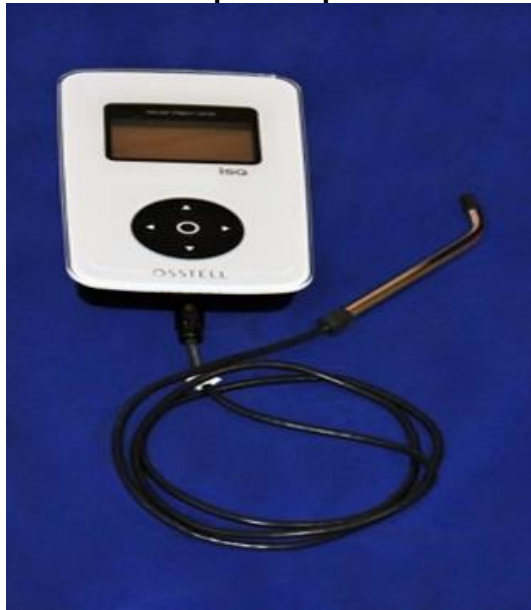
Figura 3 - Aparelho mensurador de frequência por ressonância em ISQ - Osstell®
