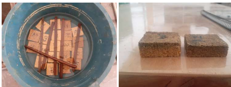
(a) Corpos de prova imersos em água (b) Corpos de prova após 24 horas
