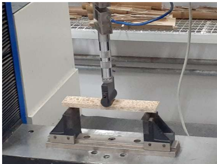
Figura 17 – Ensaio Flexão Estática
