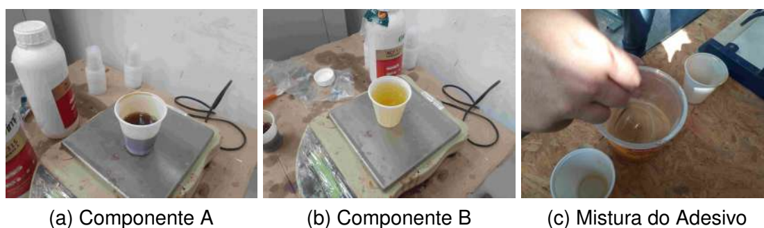
Figura 12 – Preparação do Adesivo
