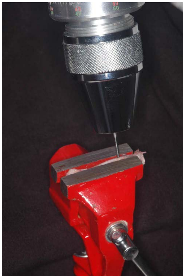
Figura 5 - Peça estabilizada em morsa para avaliação biomecânica.
