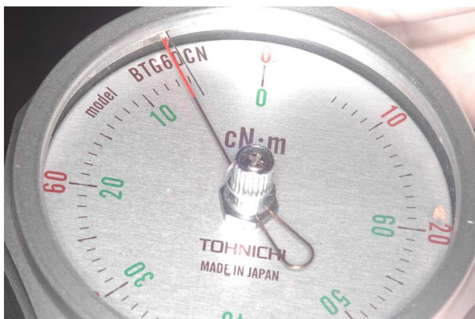
Figura 6 - Contra torque de remoção dos implantes.
