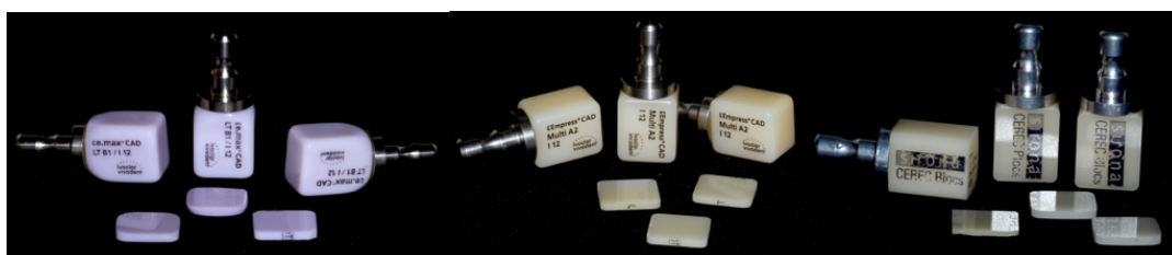
Figura 4 - Espécimes de IPS E.max CAD, IPS Empress CAD e Cerec Blocs com 2,0 mm de espessura, respectivamente, após o polimento óptico.
