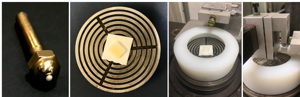
Figura 6 - Componentes do tribômetro: a) esfera de óxido de zircônio acoplada na ponta do pino, b) espécime de cerâmica CAD/CAM colado no disco com fita dupla-face (Scotch Fixa Forte Externa, 3M, São Paulo, Brasil), c) dispositivo acoplado no disco para permitir que o espécime fique submerso na saliva e d) pino em contato com o disco durante o ensaio.
