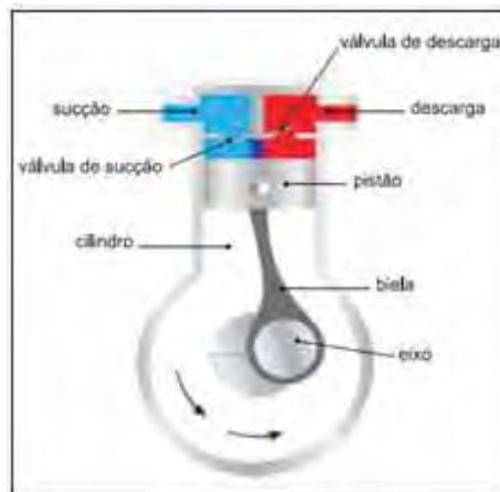
Figura 5: Compressor alternativo
