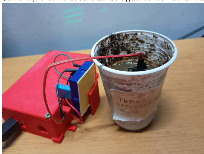
Figura 9: Calibração terra saturada de agua sensor de umidade do solo.
