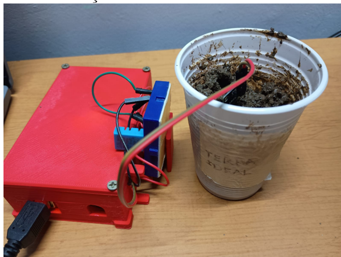
Figura 8: Calibração terra ideal sensor de umidade do solo .
