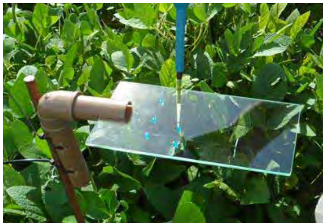
Figura 11. Aplicações das gotas sobre lâmina de vidro.
