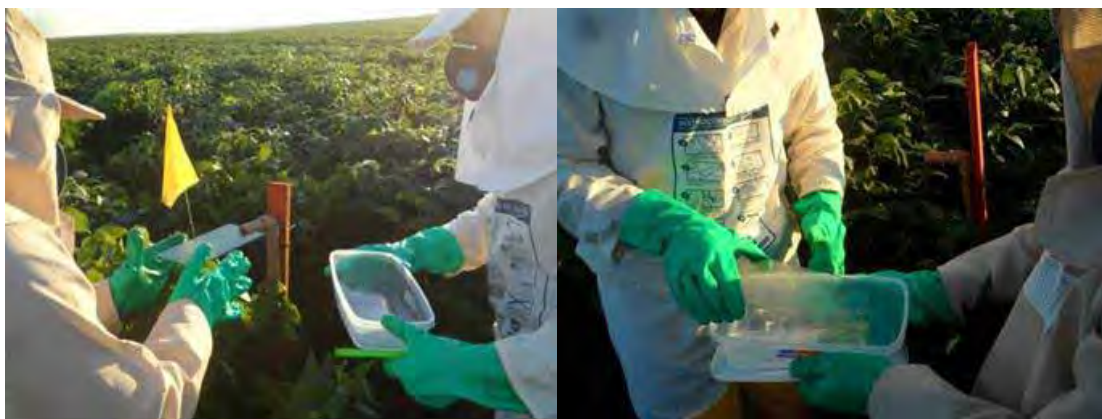
Figura 8. Lâmina colocada na altura da cultura da soja sendo retirada para acomodação em recipiente plástico para posterior extração do produto.
