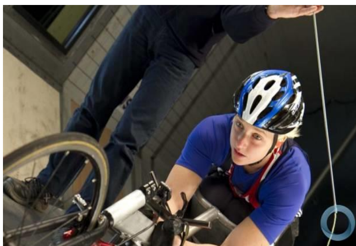
Figura 3. Cadeira de rodas sendo testada dentro de um túnel de vento.
