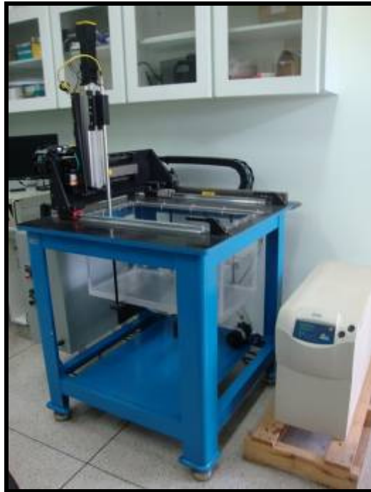
Figura 35- Equipamento de Ultrassom utilizado.
