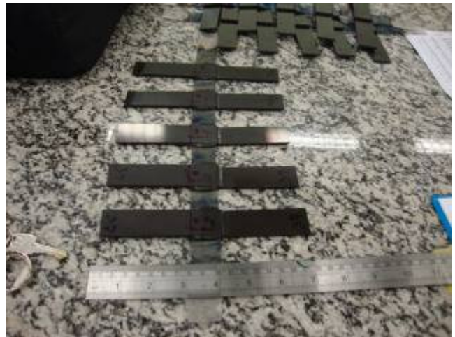
Figura 50- Modo de ensaio durante a soldagem de testes de Lap Shear do compósito PEI/fibra de carbono.
