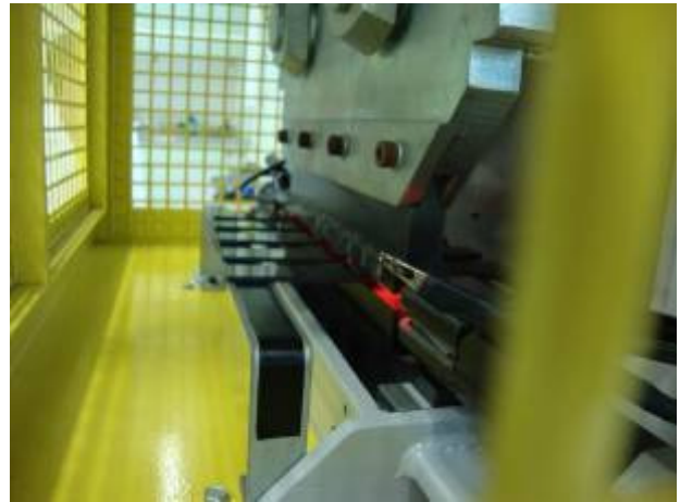
Figura 48- Soldagem das amostras do compósito PEI/fibra de carbono destinadas aos testes de Lap Shear
