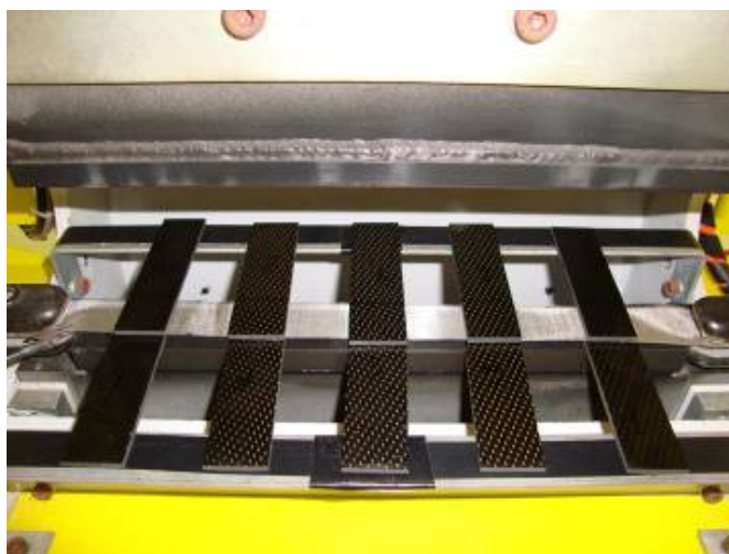
Figura 73- Amostras de PEI/fibras de carbono dispostas para a soldagem utilizando como elemento resistivo uma malha de aço inox de 100 mesh.
