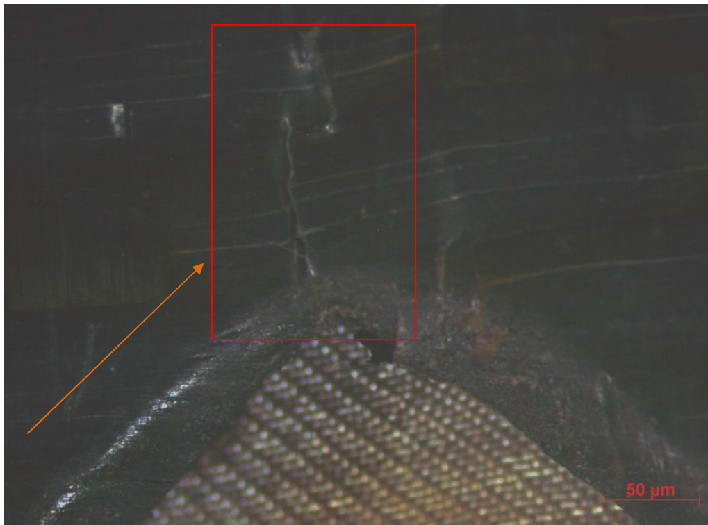
Figura 96 - Imagem por microscopia óptica do laminado não soldado após o ensaio de Iosipescu, com ampliação de 8 X.
