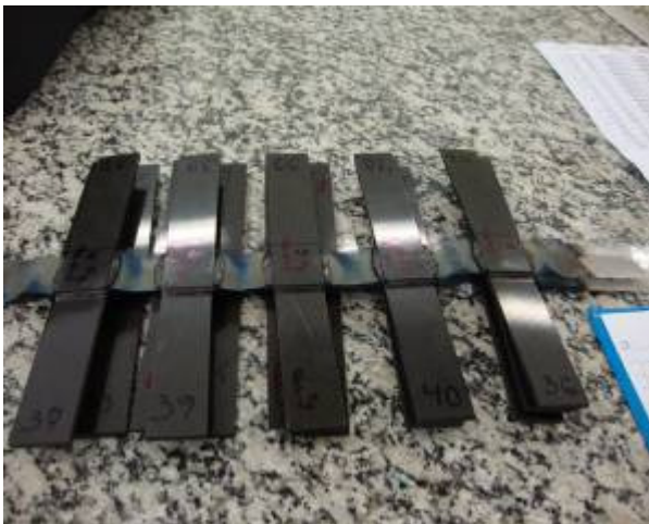
Figura 49- Modo de ensaio antes de soldagem de testes de Lap Shear do compósito PEI/fibra de carbono.
