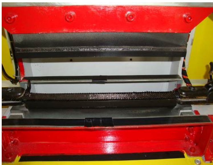
Figura 77- Imagem da disposição da fibra de carbono para a soldagem dos laminados.
