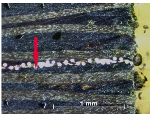
Figura 87 – Microscopia da região transversal da amostra de PEI/fibras de carbono soldado (20X).
