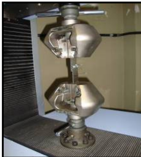
Figura 52- Detalhe da amostra no momento da falha durante o ensaio Lap Shear .
