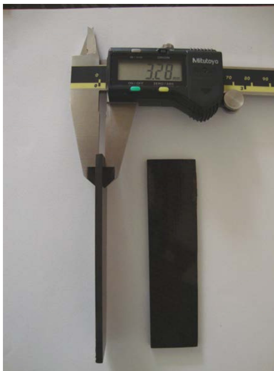
Figura 30- Amostras dos laminados PEI/ fibra de carbono dimensionadas para os ensaios de Lap Shear .
