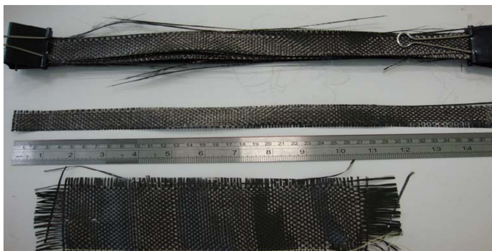
Figura 33- Imagens do tecido de fibra de carbono utilizadas como elemento resistivo na soldagem dos laminados.
