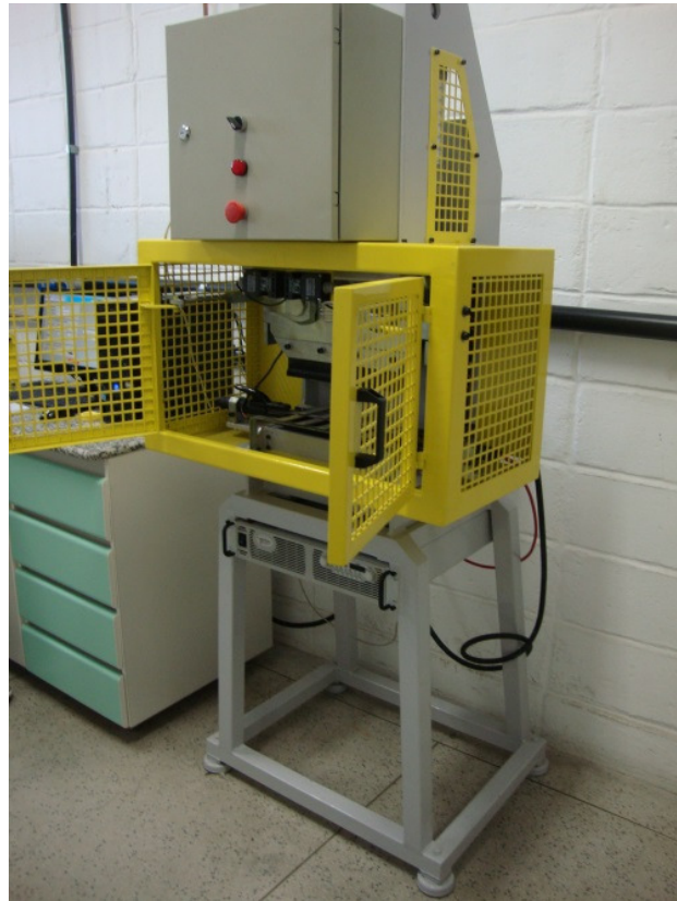
Figura 45- Foto da máquina de soldagem por resistência elétrica utilizada no presente trabalho
