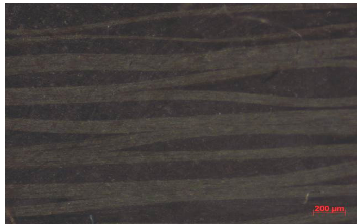
Figura 54- Imagem da seção transversal da amostra do compósito PEI/fibra de carbono com ampliação de 20X.
