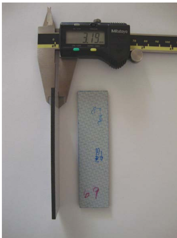
Figura 28- Amostras dos laminados PEI/ híbrido dimensionadas para os ensaios de Lap Shear .
