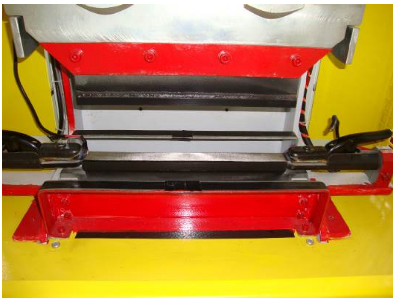
Figura 76- Imagem da disposição das malhas metálicas para a soldagem dos laminados.
