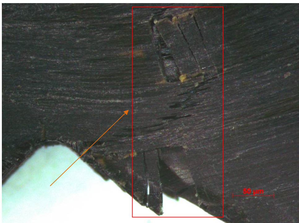
Figura 95 - Imagem por microscopia óptica do laminado não soldado após o ensaio de Iosipescu, com ampliação de 8 X.
