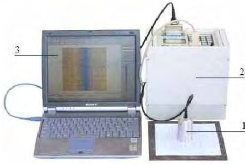
Figura 41 – Equipamento portátil STRESSVISION.
