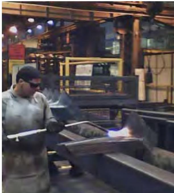
Figura 2 – Aquecimento das peças para alívio das tensões residuais.
