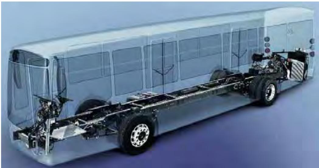
Figura 1- Estrutura de um onibus (VOLKSBUS, 2011).
