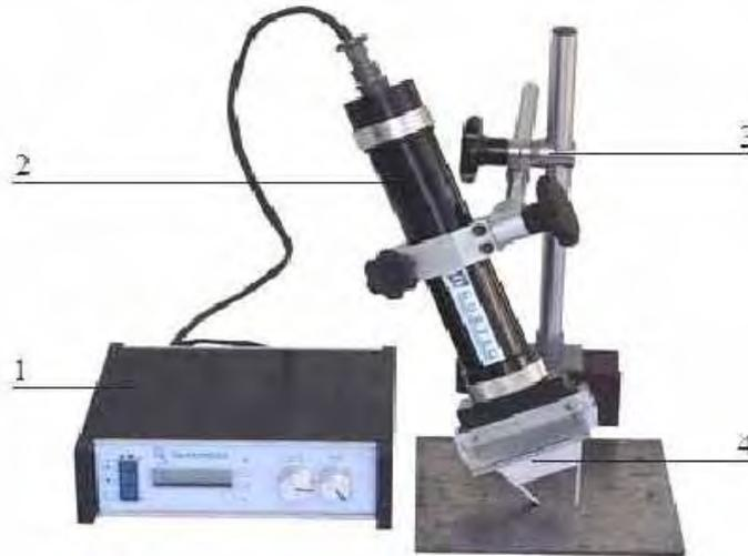
Figura 46 – Equipamento portátil RAYSTRESS.
