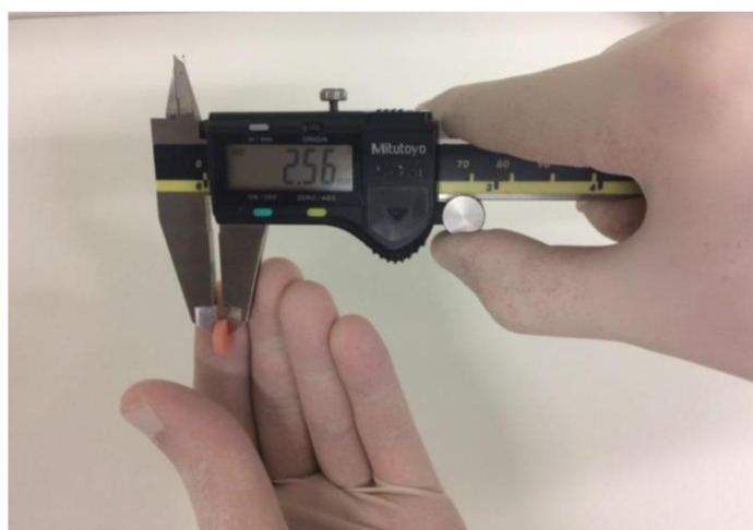
Figura 8 - Padronização da espessura das amostras
