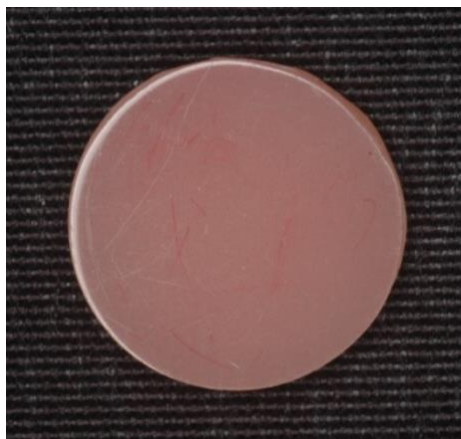
Figura 7 - Amostra de RAAT após acabamento e polimento
