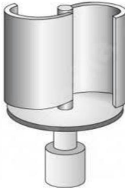
Figura 4 – Turbina eólica vertical Savonius
