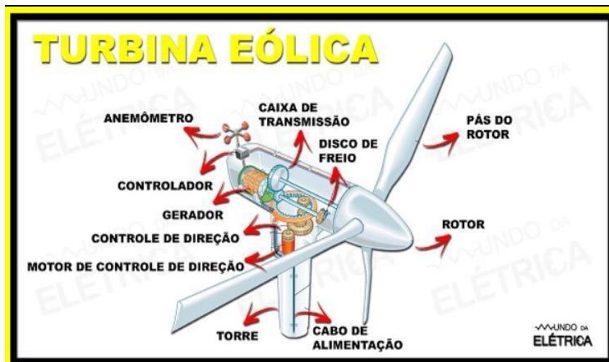
Figura 1 – Representação dos componentes da turbina eólica
