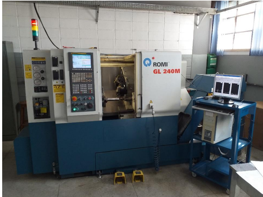
Figura 31 – Centro de Torneamento CNC Romi modelo GL 240M
