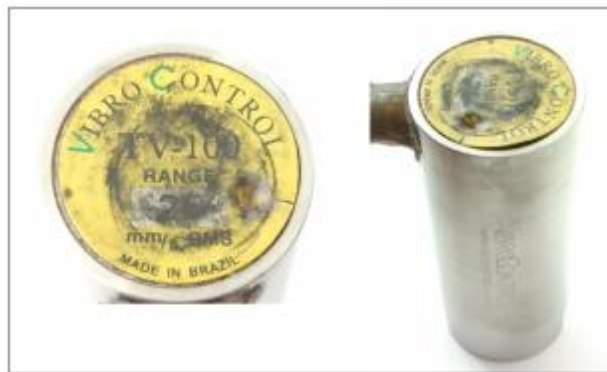
Figura 35 – Sensor piezelétrico, marca Vibro Control, modelo TV100
