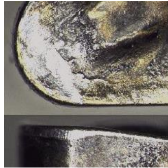
Figura 13 – Desgaste de flanco em uma ferramenta de corte
