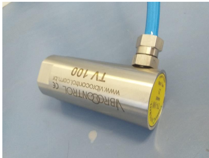
Figura 36 - Sensor piezelétrico utilizado nos ensaios.
