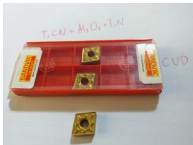
Figura 29 - Ferramenta de metal duro com revestimento CVD da marca Sandvik.
