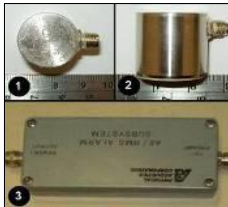
Figura 37 – Módulo de emissão acústica (1), sensor (2) e amplificador (3)
