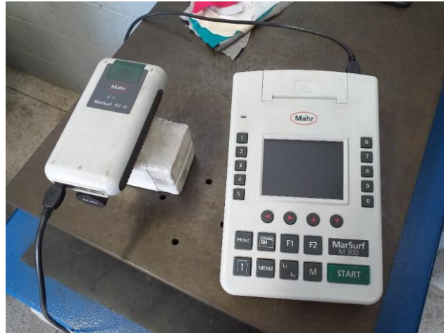
Figura 32 - Rugosímetro marca Mahr modelo Marsurf M300
