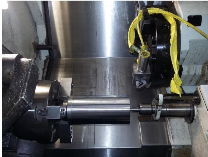
Figura 25 - Ensaio com a ferramenta de CBN
