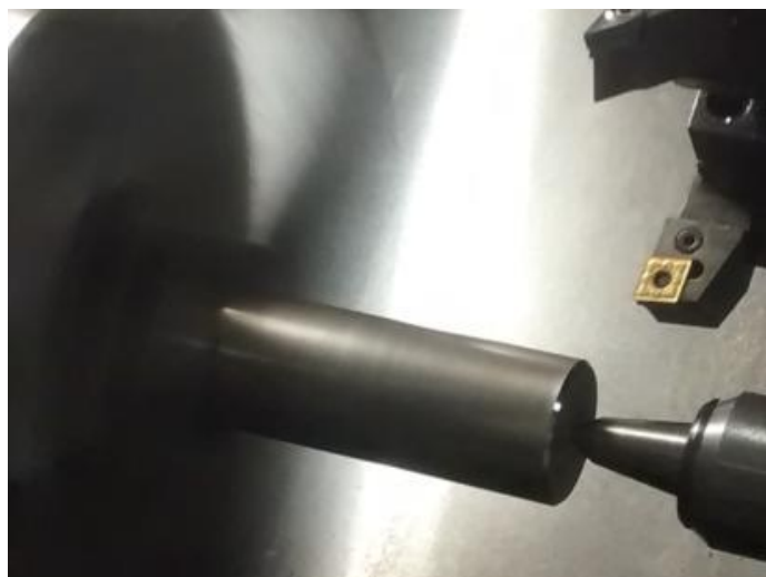
Figura 24 – Corpo de prova fixado ao Centro de Torneamento.
