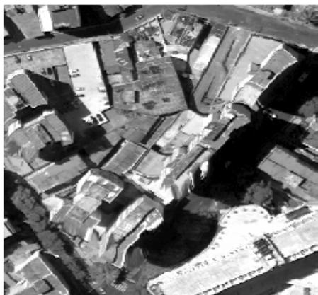
**Figura 3.4** Distorção na forma geométrica de algumas edificações, provocando deslocamento e inserção de bordas (imagem pancromática – HRSC-AX).
