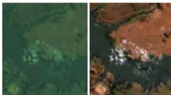
**Figura 2.21** Resultado da correção radiométrica em imagem CBERS (R3G2B1). Adaptado de Polidorio *et al.* (2005b).
