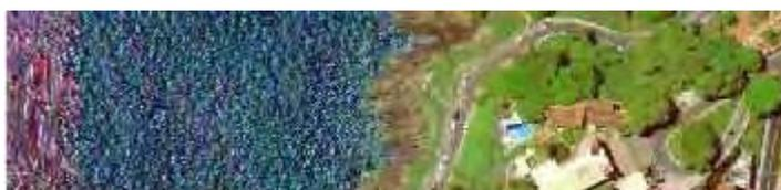
**Figura 4.35** Problemas de registros de alvos que se movem (superfície do corpo d'água) entre as imagens R, G e B adquiridas pela câmara HRSC-AX.
