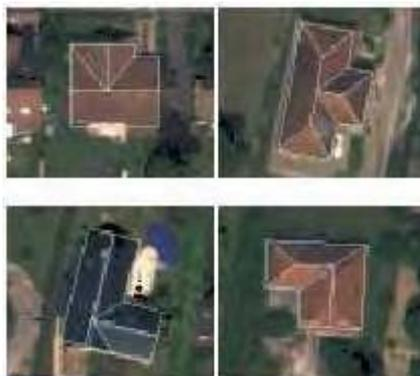
**Figura 1.1** Exemplo de reconstrução de telhados de edificações. Adaptado de Taillandier e Deriche (2004).
