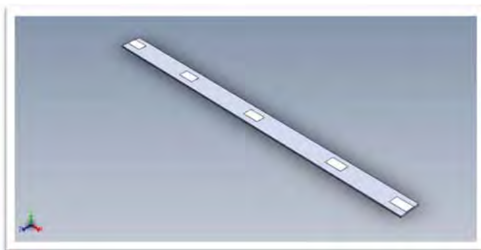
Figura 19 – Ilustração da Viga com os sensores PVDF(s)
