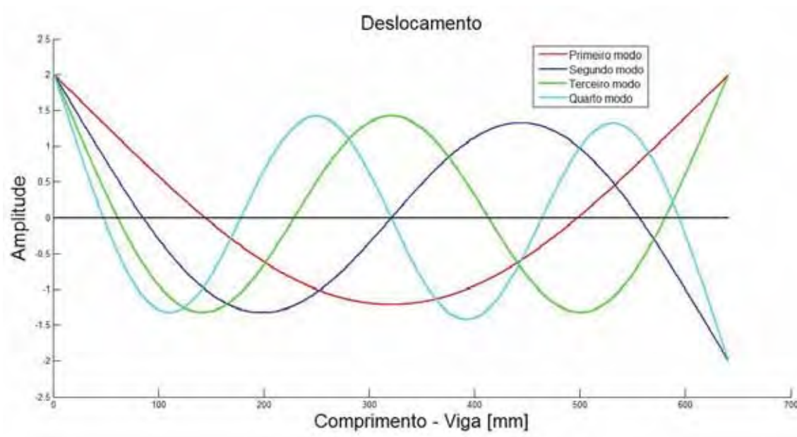
Figura 15 – Modos de vibrar para uma viga contínua em deslocamento.
