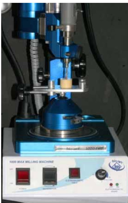
Figura 1 - Fresadora 1000Max Milling Machine ( Bio-Art Equipamentos Odontológicos Ltda).
