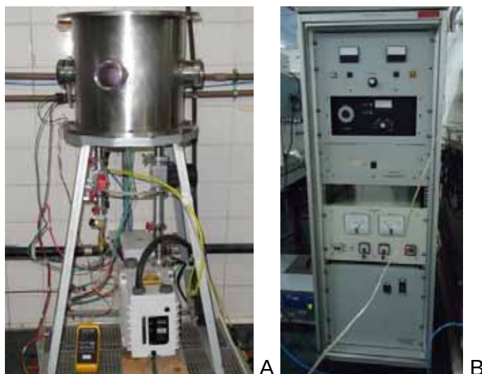
Figura 5 - A) reator para deposição dos filmes de DLC por PECVD; B) fonte de descarga contínua acoplada ao reator.
