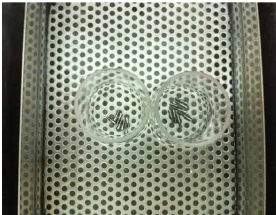
Figura 9 – Limpeza dos parafusos em cuba ultrassônica por 15 minutos.
