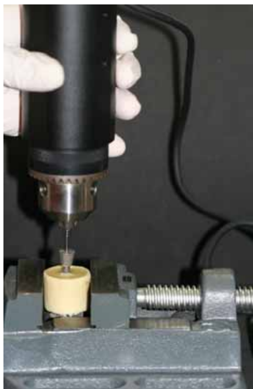
Figura 17 - Aferição do torque final, após ciclagem mecânica com Torquímetro Digital Portátil TQ-680.
