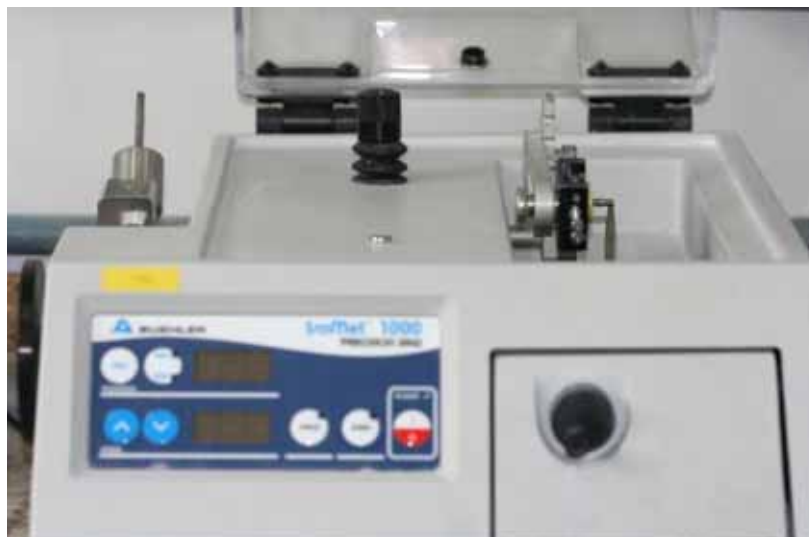
Figura 11 - Cortadeira Isomet 1000, (Buehler Ltd., USA).
