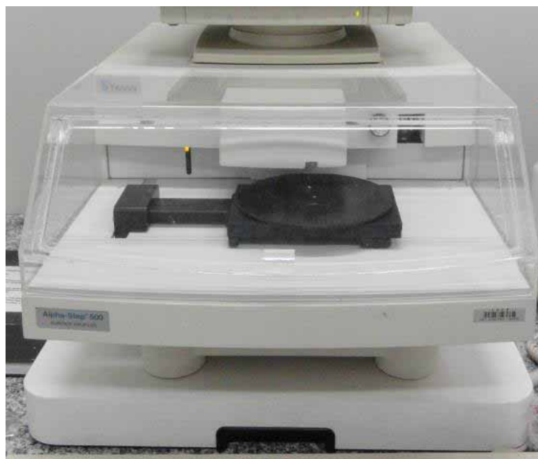
Figura 6 – Perfilômetro utilizado para medir a espessura dos filmes de DLC.
