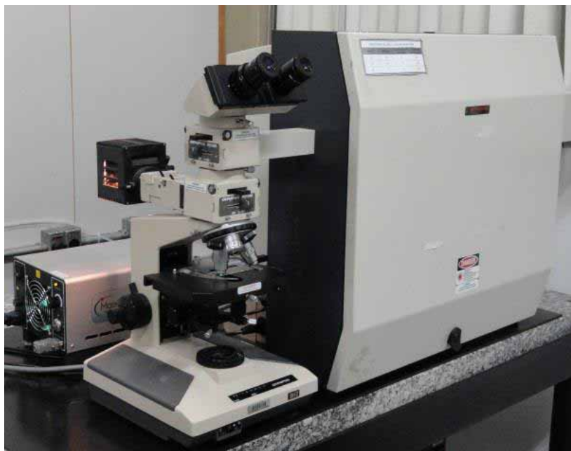
Figura 7 – Sistema utilizado para a análise de espectroscopia de retro espalhamento Raman.
