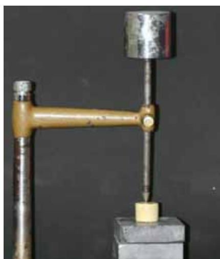
Figura 14 - Cimentação das coroas com auxílio do dispositivo de carga de 500 g.
