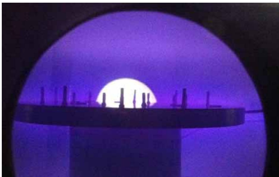
Figura 4 - Vista do porta-amostras durante o processo de deposição (plasma de argônio) através da janela do reator.
