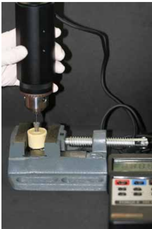
Figura 15 - Aplicação do torque inicial com Torquímetro Digital Portátil TQ-680.
