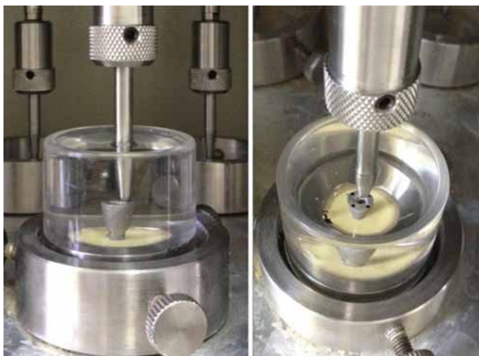
Figura 16 - Ciclagem mecânica - Simulador de Fadiga Mecânica ER-11000 Plus-ERIOS®
