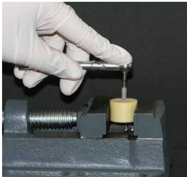
Figura 3 - Instalação do implante com catraca manual.
