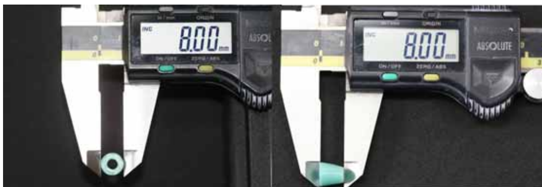
Figura13 - Enceramento das coroas, medição com paquímetro digital.
