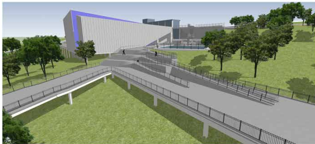
Perspectiva 16. O conjunto de escadas e rampas conecta caminhos vindos de pontos diferentes, vencendo uma altura de 4 metros.
