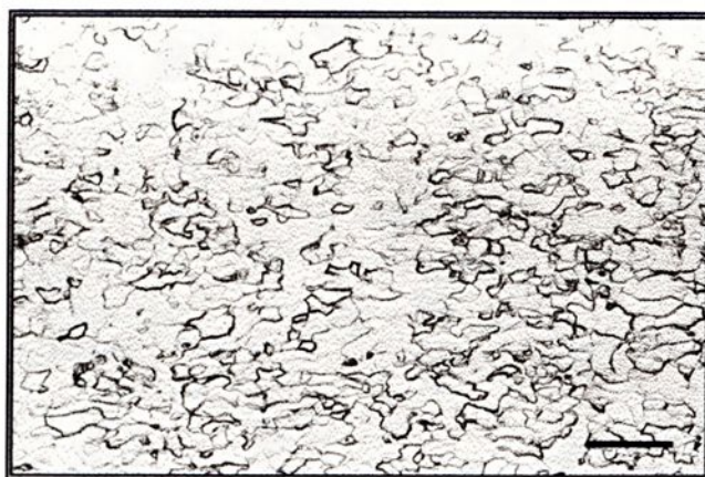
Figura 22 - Microestrutura obtida em MO do aço IF-Ti na condição como recebido no sentido transversal da laminação. Ataque com Nital 2% em volume. Os grãos apresentaram ligeiro alongamento. Barra: 100 \mu m.
