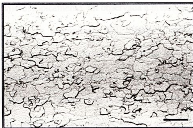
Figura 25 - Micrografia do aço IF-Ti apresentando a microestrutura da região do fundo do copo estampado. Nota-se ligeiro alongamento na face externa do fundo do copo formado. Barra 100 \mu m. Ataque com Nital 2%.
