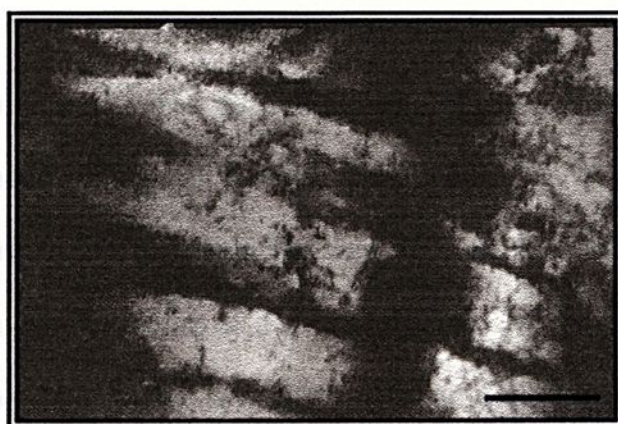
Figura 30 - Micrografia eletrônica (MET) do aço IF-Ti nas mesmas condições da Figura 29, porém com maior ampliação. Notam-se, com maior detalhe, as bandas de escorregamento. Barra: 1\mu\text{m} .
