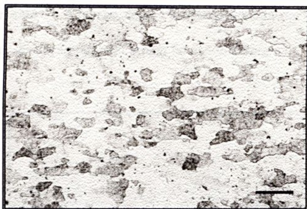
Figura 23- Micrografia do aço IF-Ti apresentando a microestrutura da região de dobramento do copo embutido. Nota-se pouco alongamento gerado por tensões de tração e compressão. Barra: 100 \mu m. Ataque com Nital 2%.
