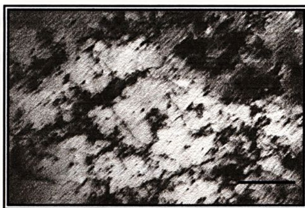
Figura 34- Micrografia eletrônica (MET) do aço IF-Ti estampado mostrando a resposta de forças de compressão na aba do copo formado. Barra: 1,5 \mu m.
