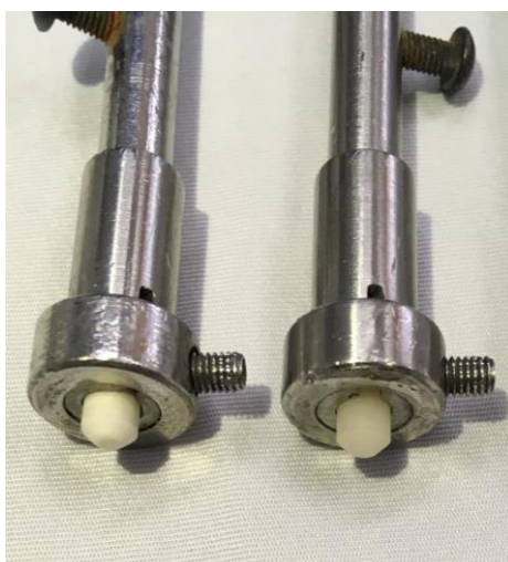
Figura 13 – Pistões adaptados nos mandris: esteatita e PIC
