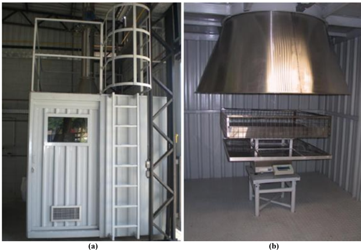
Figura 15- Equipamento de queima: (a) visão geral do equipamento e (b) detalhes da bandeja de queima.
