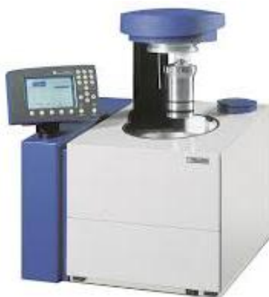
Figura 9- Bomba calorimétrica isotérmica modelo IKA C-5000
