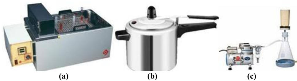
Figura 7- Procedimentos para determinação do teor de lignina insolúvel: (a) material em banho Maria; (b) cozimento em panela de pressão e (c) filtragem.
