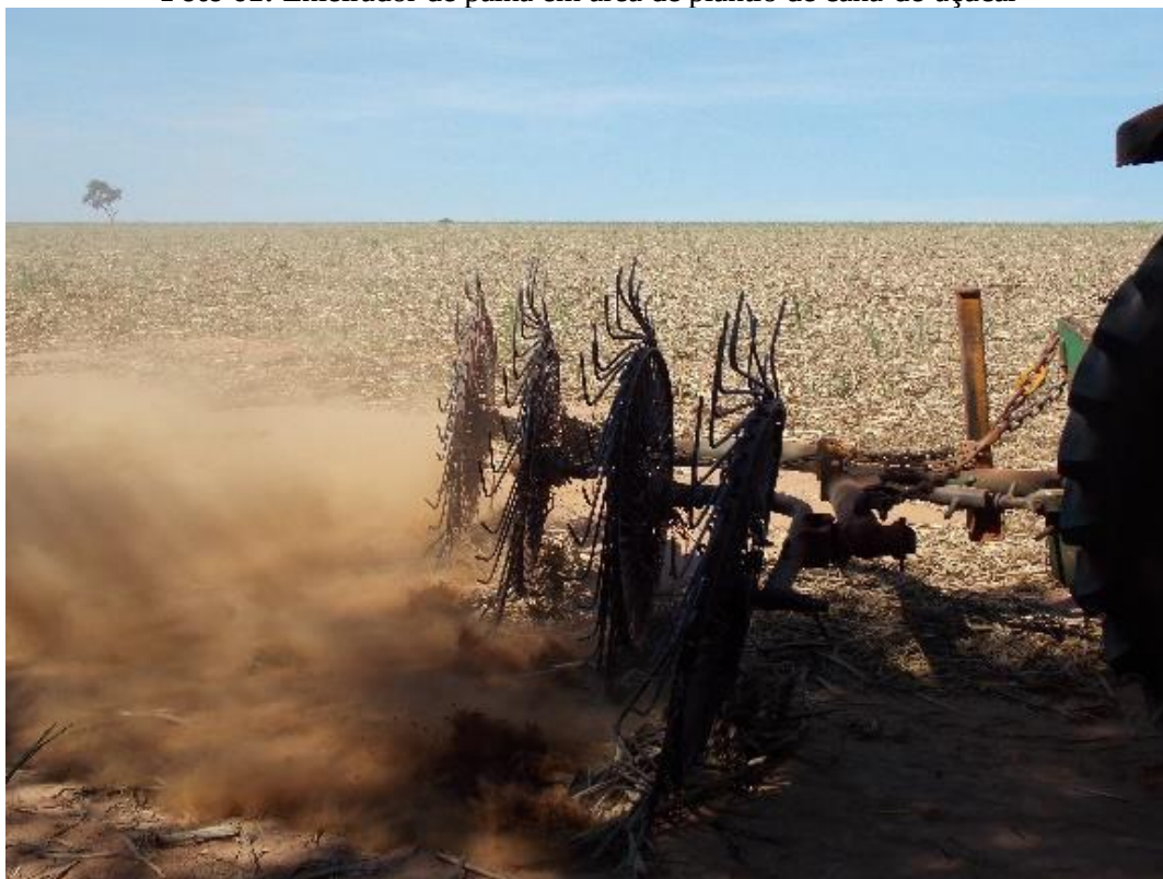
Foto 61: Enleirador de palha em área de plantio de cana-de-açúcar
