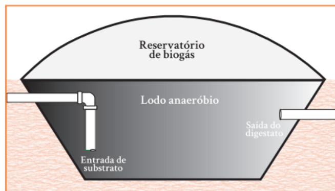
Figura 6 - Esquematização do biodigestor de lagoa coberta (BLC)
