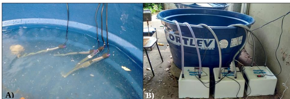
Fig. 5. Tanques de fibra de vidro em que os animais ficaram alocados. A temperatura de 27°C foi controlada com a ajuda de termostatos (A), e a temperatura de 17°C, com a ajuda de refrigeradores (B). Fonte: própria autora.
