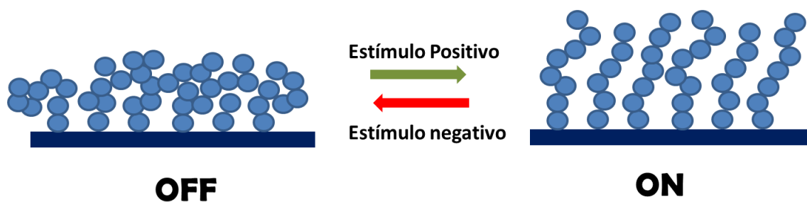
Figura 3. Polímero escova ancorado ao substrato sólido. Recebendo-se estímulo positivo a configuração das cadeias encontra-se favorável ao sinal (ON), recebendo estímulo negativo, configuração desfavorável (OFF).
