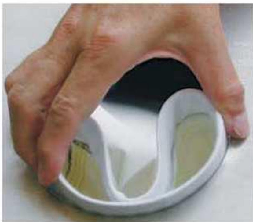
Figura 10: Manga filtrante com anel de aço mola em procedimento de instalação. (Ivell, 2011)
