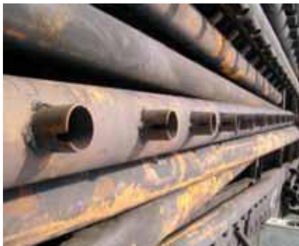
Figura 11: Danos no tubo ejetor. (Zhou, R.; Shen, H.; Zhao, M. (2012))
