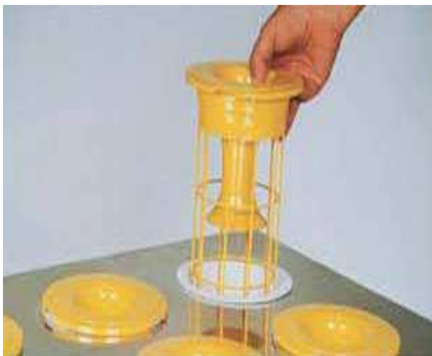
Figura 9: Gaiola com venturi em procedimento de instalação.(Ivell, 2011)
