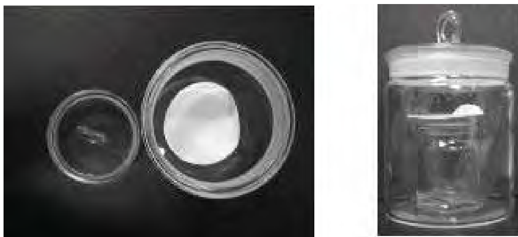
Figura 17 - Sistema utilizado para efetuar o estudo do comportamento vapocrômico da espécie [\text{Ni}_2(\mu\text{-Cl})_2\text{Cl}_2(\text{HdmPz})_4] ( 11 ).
