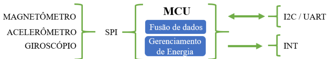
Figura 20 – Diagrama de Blocos Sensor BNO055
