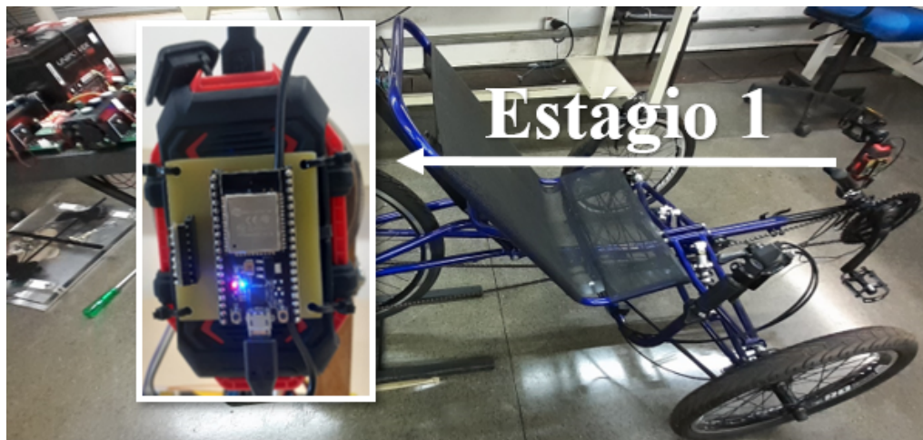
Figura 40 – Montagem do sistema medição (estágio 1).
