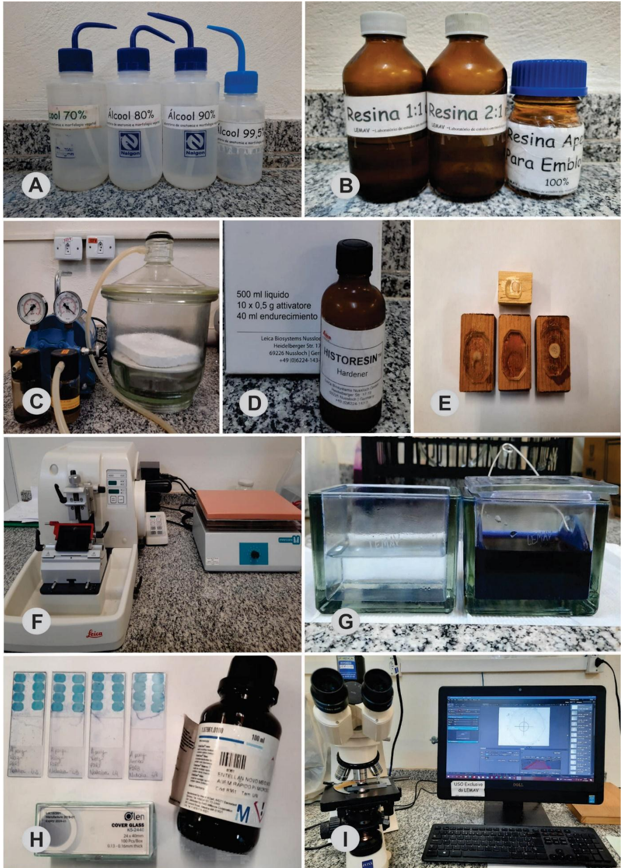
Figura 2: Materiais e métodos utilizados. A: desidratação em série etílica com álcoois 70%, 80%, 90% e 100%; B: infiltração gradativa em resina; C: bomba a vácuo; D: hidróxi-etil-metacrilato (Leica HistoResin); E: blocos; F: micrótomos e chapa de aquecimento; G: coloração com azul de toluidina 0,05%; H: montagem das lâminas com “Entellan”; I: realização das fotomicrografias.
