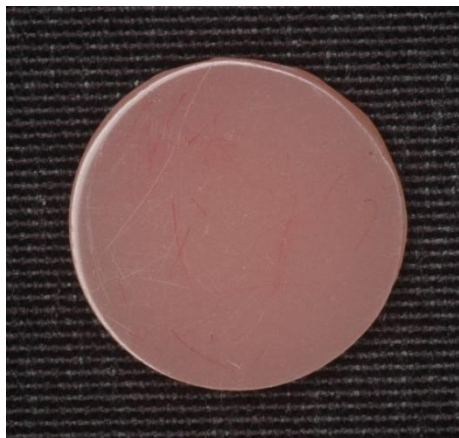
Figura 7 - Amostra de RAAT após acabamento e polimento
