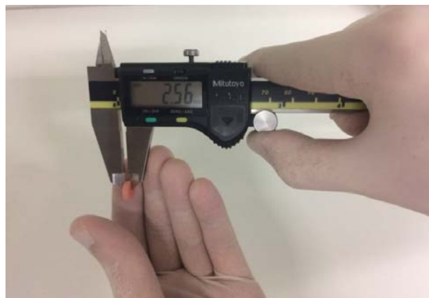
Fig. 8. Padronização da espessura das amostras.
