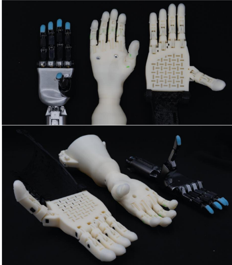
Figura 13 - Diferenças no posicionamento do polegar entre os três modelos de dispositivos.
