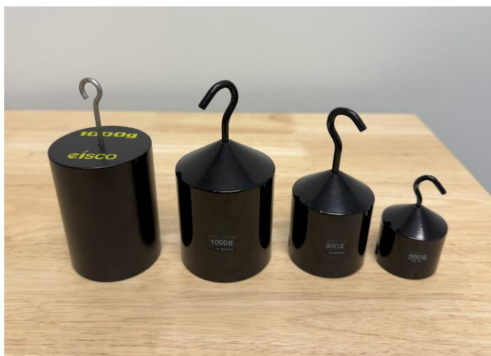
Figura 6 - Pesos utilizados para acionar o mecanismo das próteses mecânicas.
