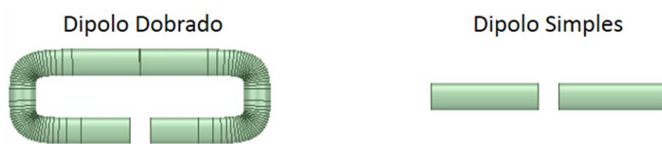
Figura 5: Diferença geométrica entre um dipolo dobrado e um dipolo simples.
