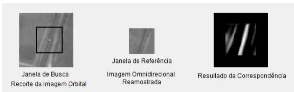
Figura 6.11 - Janela de busca, referência e resultado do processo de correlação cruzada em locais onde não há características que identifiquem o ponto correto de correspondência dentro da janela de busca.
