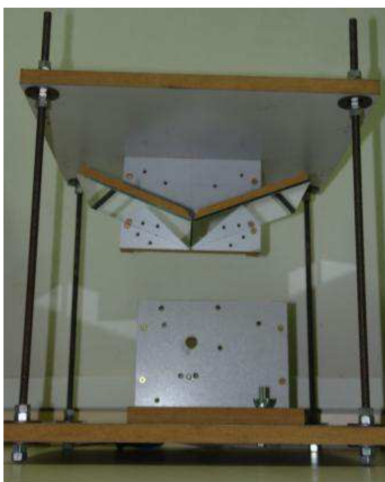
Figura 3.1 - Protótipo para determinar a configuração do espelho.
