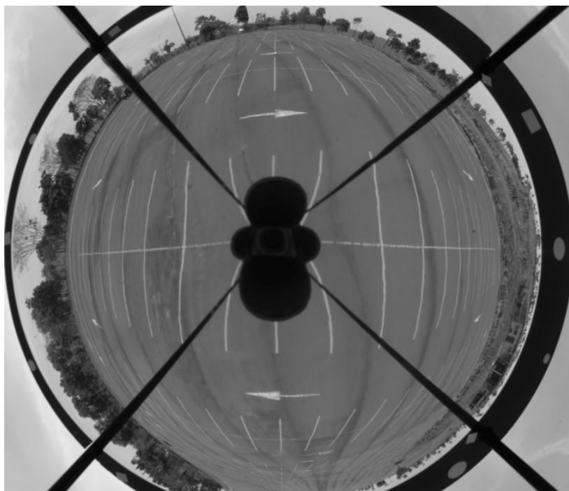
Figura 4.19 - Imagem omnidirecional catadióptrica capturada com o sistema construído.
