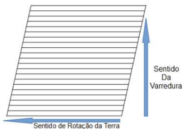
Figura 2.3 - Efeito na imagem causado pelo movimento de rotação da Terra. Adaptado de Richards (2013)
