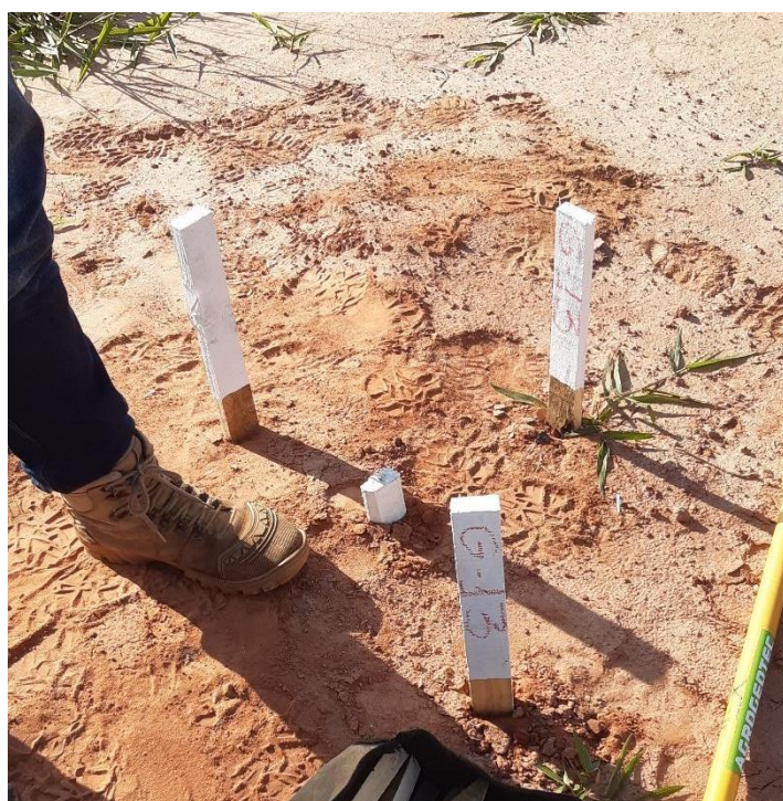
Figura 27 – Indicação de um ponto para estacionar a Estação Total. Fonte: O Autor
