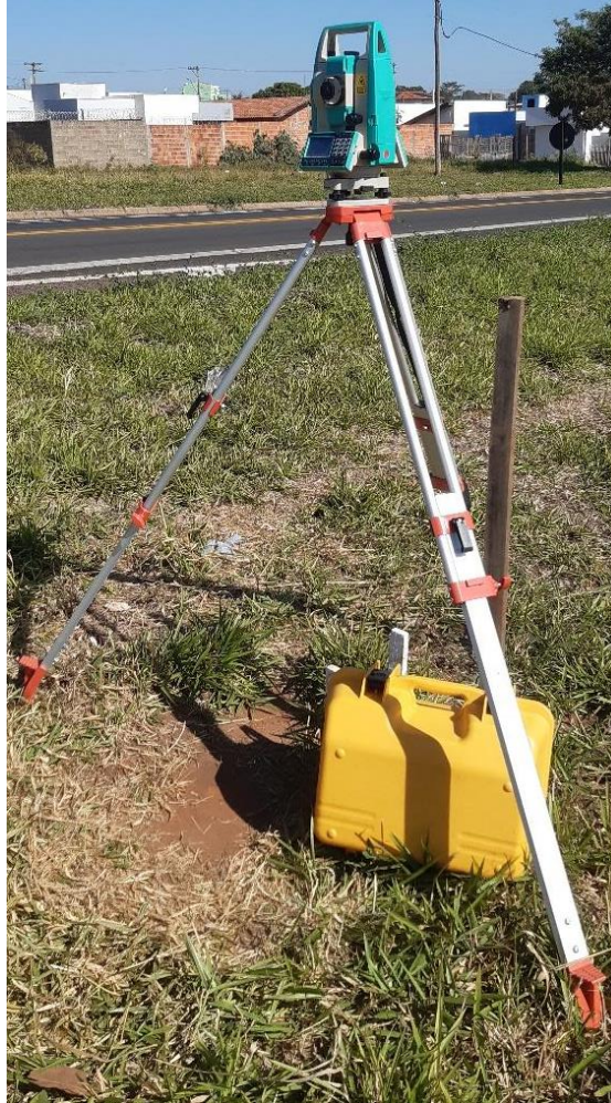
Figura 29 – Equipamento estacionado e nivelado. Fonte: O Autor
