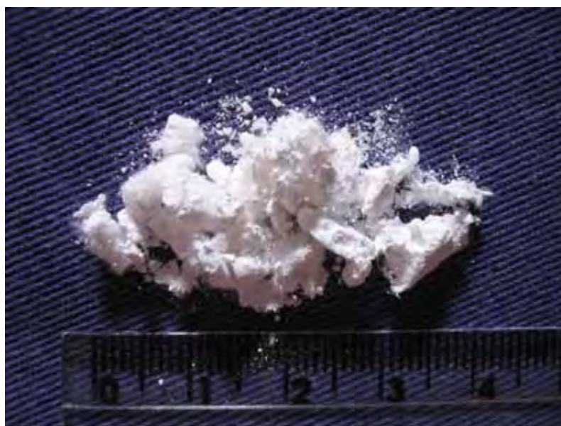
Figura 2: Imagem fotográfica do cimento de fosfato de cálcio adicionado com fibras de náilon para o preenchimento de falha óssea.
