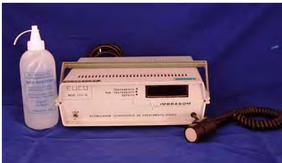
Figura 3: Imagem fotográfica do aparelho de ultra-som, modelo 1131-G (Imbrassom Ind. e Com.) e gel acoplante hidrossolúvel.
