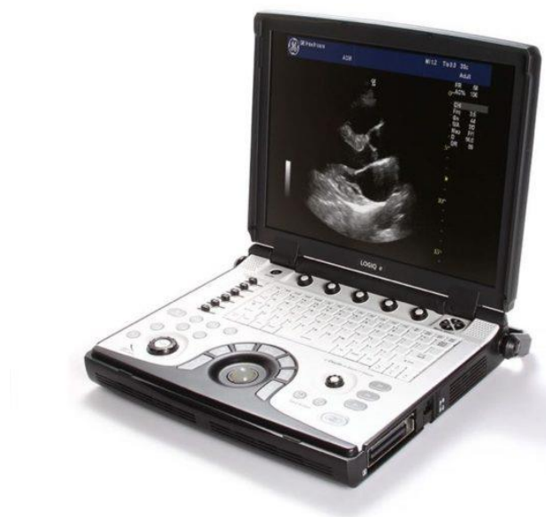
Figura 6. Ultrassom de alta frequência LogicE GE® 22 MHz (GE Eletronics®, Boston, Massachusetts, Estados Unidos)
