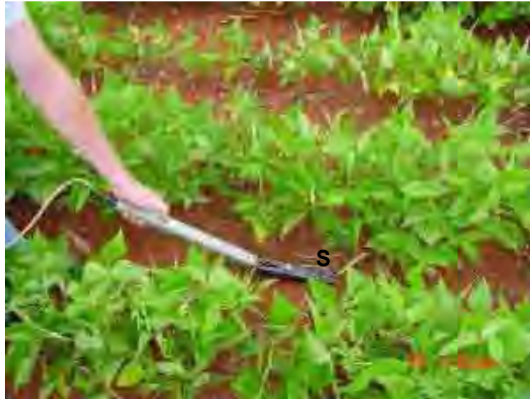
FIGURA 10. Detalhe da avaliação do IAF com posicionamento do sensor ( S ) abaixo do dossel.
