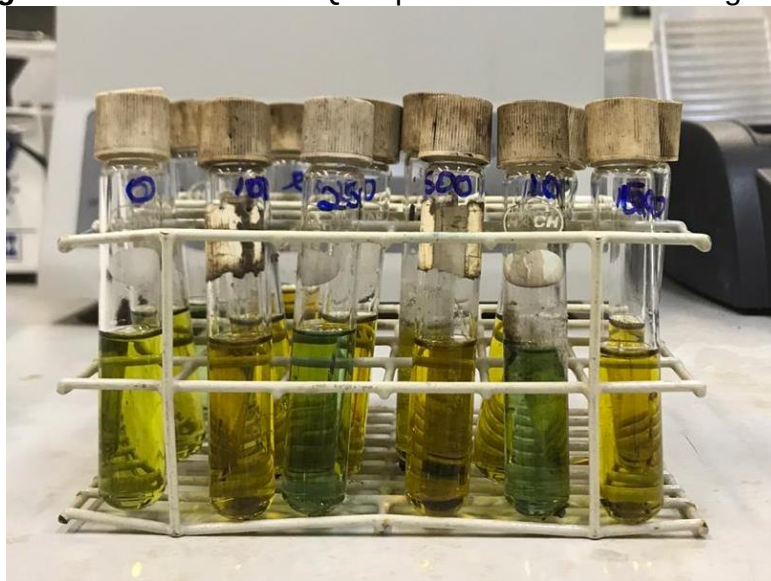
Figura 4: amostras de DQO após saírem do termo-digestor.
