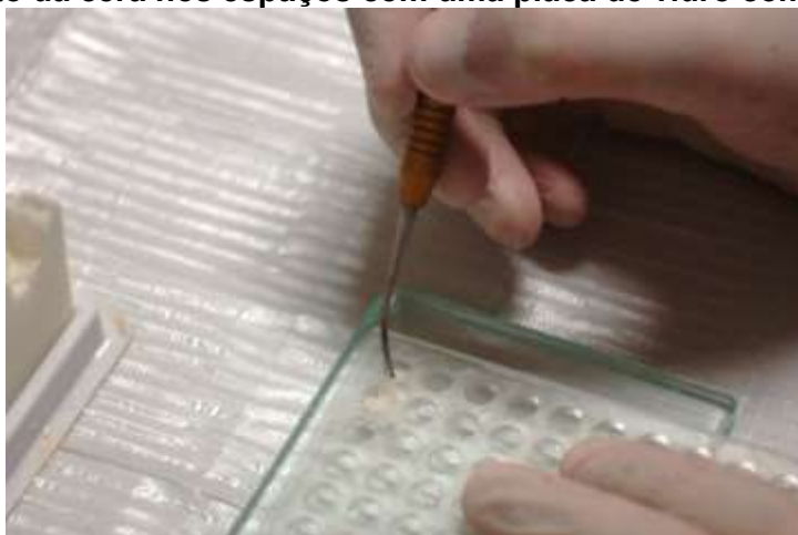
Figura 9 - Gotejamento da cera nos espaços com uma placa de vidro como anteparo
