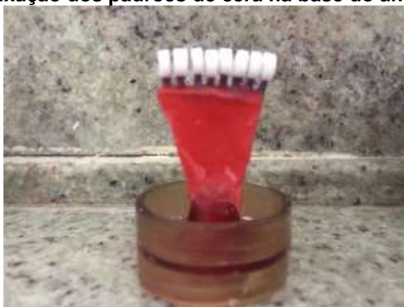
Figura 13 - Fixação dos padrões de cera na base do anel de fundição
