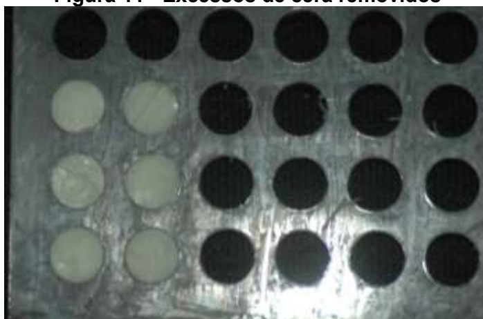
Figura 11 - Excessos de cera removidos
