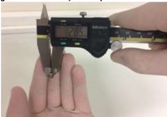
Figura 17 - Padronização da espessura das amostras
