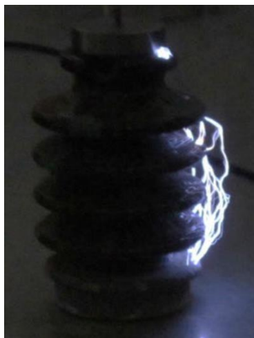
Figura 2.3 – Falha em isolador.
