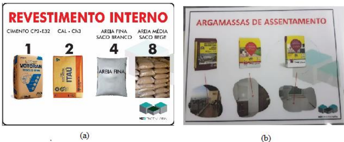
Figura 9 – Placas didáticas e informativas: (a) Traço de argamassa de reboco interno; (b) Locais de aplicação das argamassas colantes
