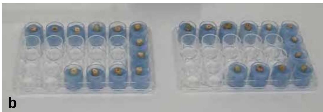
FIGURA 3 - Inclusão dos espécimes em placas de polistireno: a) preparo da resina acrílica quimicamente ativada na cor azul; b) placas azuis após inclusão dos espécimes.
