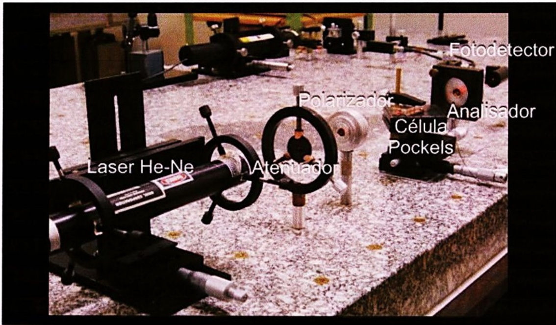
Figura 5.11 – Fotografia da montagem experimental no laboratório.
