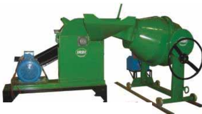
Figura 19: Conjunto desintegrador – homogeneizador (CONSECANA, 2011).
