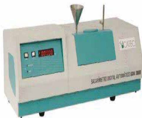
Figura 22: Sacarímetro utilizado nas análises de açúcares presentes nas soluções.
