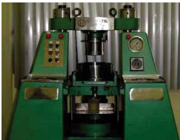
Figura 20: Fotografia da prensa hidráulica, utilizada para a prensagem das amostras de bagaço.
