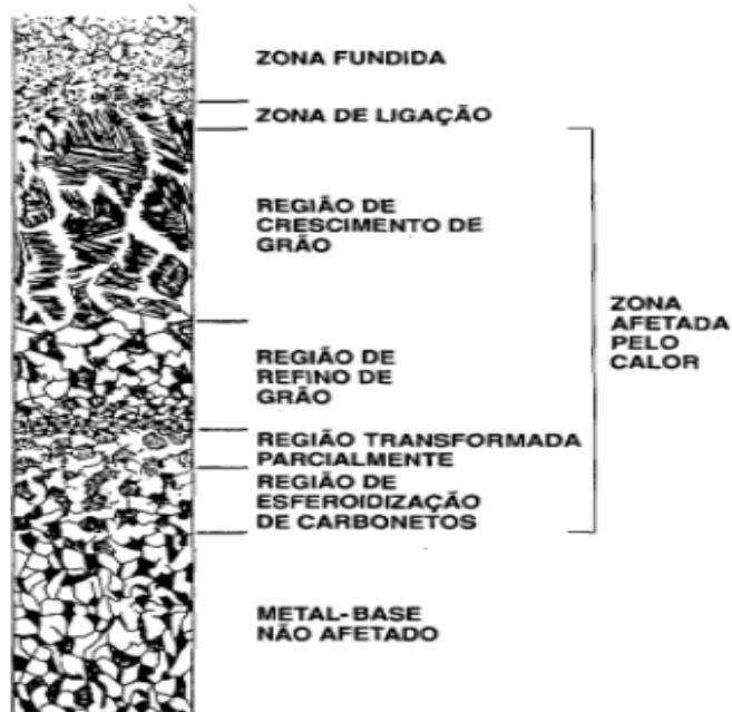
Figura 11: Microestruturas típicas da zona termicamente afetada de aços carbono
