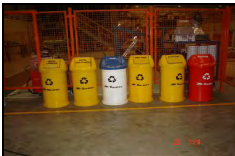
Figura 6 - Conjunto de acondicionadores da célula de manutenção - capacidade 0,2 m 3 cada.
