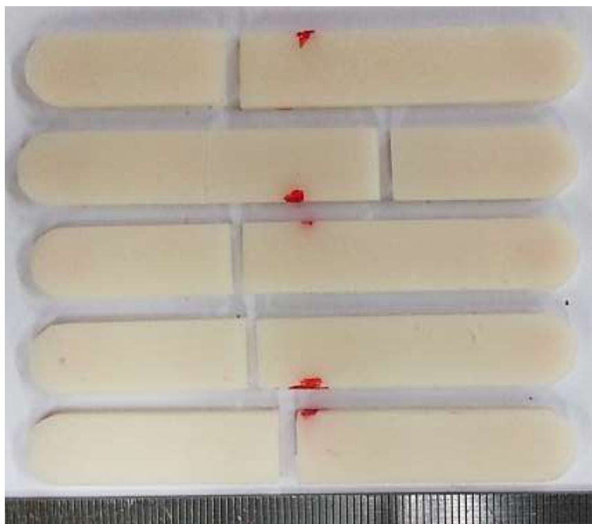
Figura 5. Exemplos de corpos de prova do Grupo 1 (cimento ósseo controle) após o ensaio mecânico de flexão.
