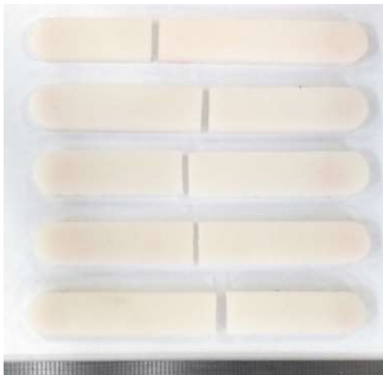
Figura 7. Exemplos de corpos de prova do Grupo 2 (cimento acrescido de nitrato de prata) após o ensaio mecânico de flexão.
