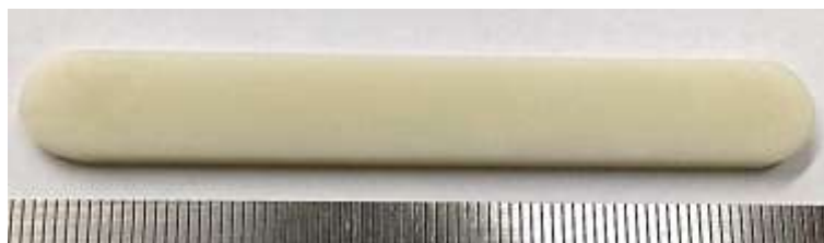
Figura 1. Exemplo de corpo de prova do Grupo 1 preparada para ser utilizada no ensaio de flexão.
