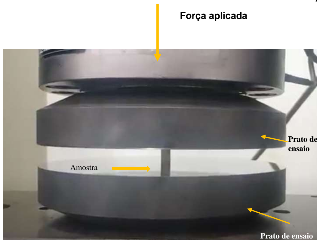
Figura 3. Ilustração da montagem do ensaio de compressão.
